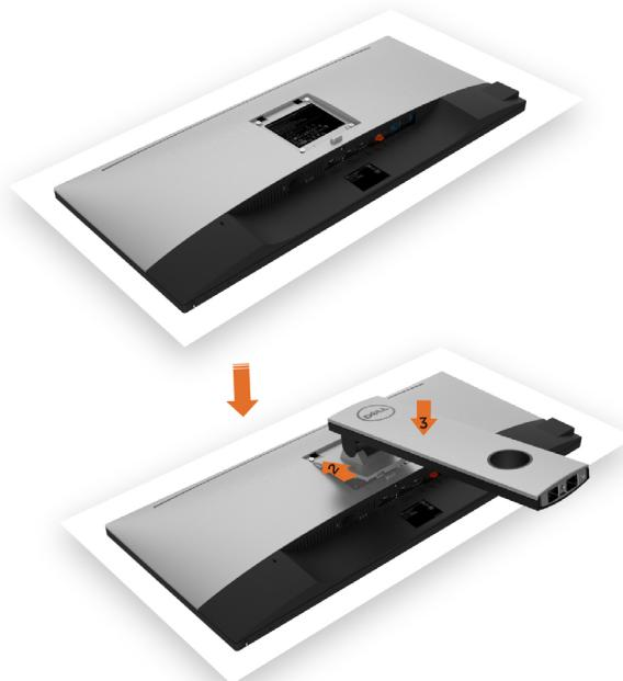
Чтобы установить монитор на стойку, выполните следующие действия:
