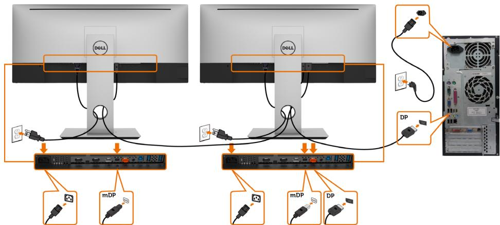
**ПРИМЕЧАНИЕ.** Монитор поддерживает функцию DP MST. Для использования этой функции видеокарта компьютера должна соответствовать спецификации DP1.2 и поддерживать режим MST.
